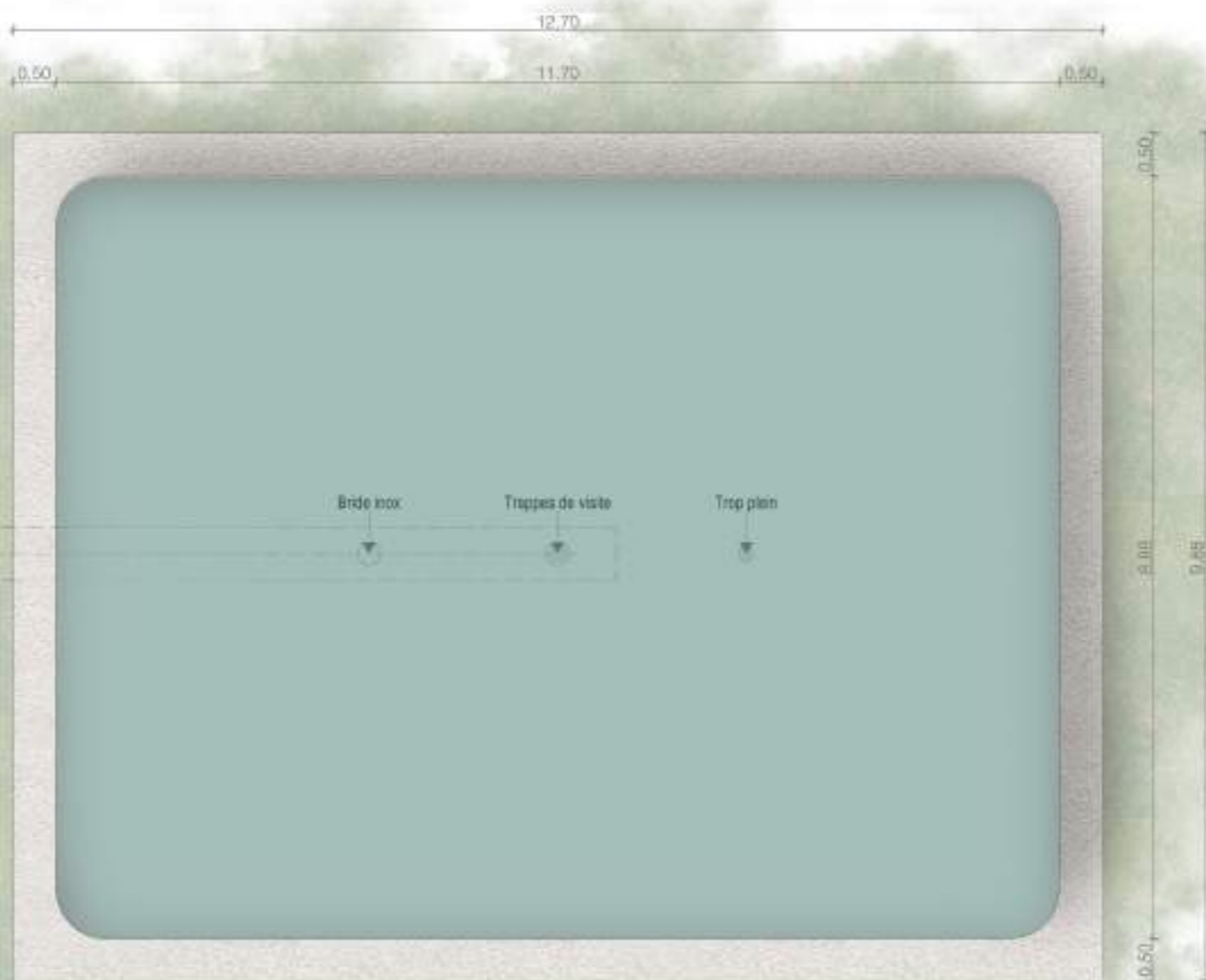
Citerne souple de 120m3 Dimensions : Longueur 11.7m, largeur 8.88m, hauteur 1.6m
